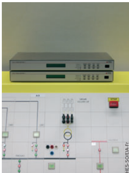
Figure 6 Mesureurs de phaseurs connectés au simulateur analogique et au système de surveillance globale («WAMS») 4)
